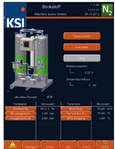
Bedienfeld der Steuerung
