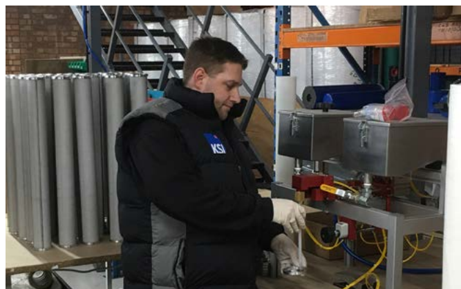
Anbringung der Endkappen mit 2-Komponenten-Kleber.
