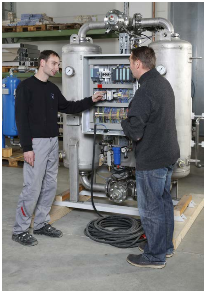
Testphase Adsorptionstrockner, warmregeneriert, Edelstahl
