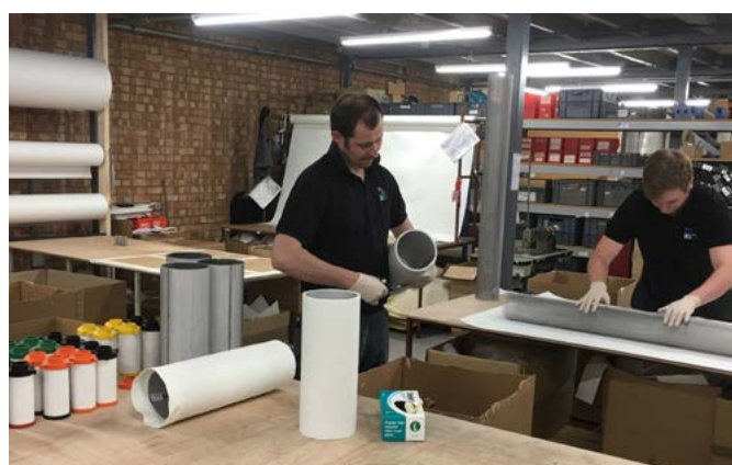
Anbringung der Endkappen mit 2-Komponenten-Kleber.
