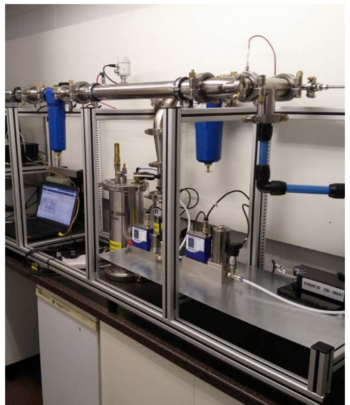
Teststation Filterelemente mit Partikelcounter
