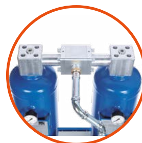
Puentes de tuberías pueden removerse fácilmente para mantenimiento
