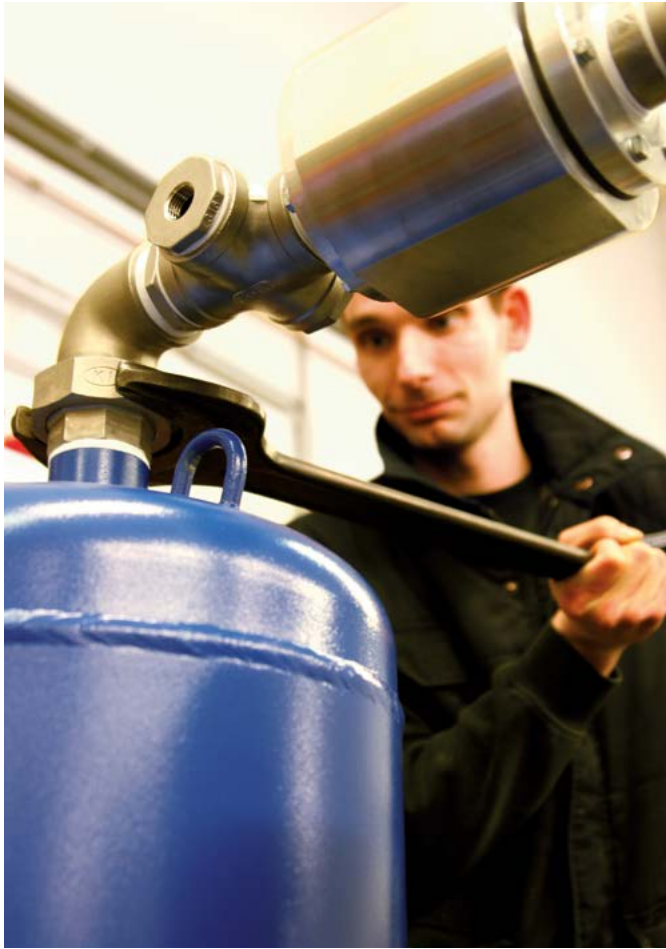
Ensamblaje final de secador de adsorción
