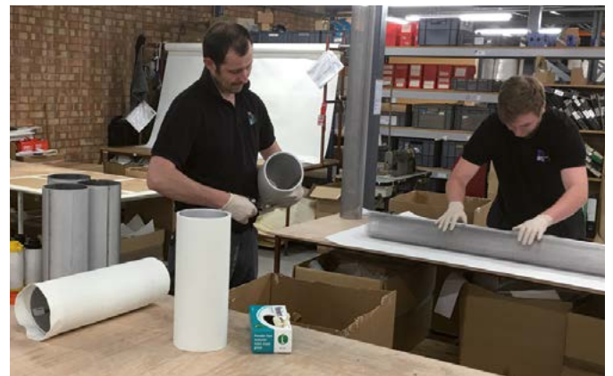
Adhesivos de dos componentes para pegar las tapas de filtro.
