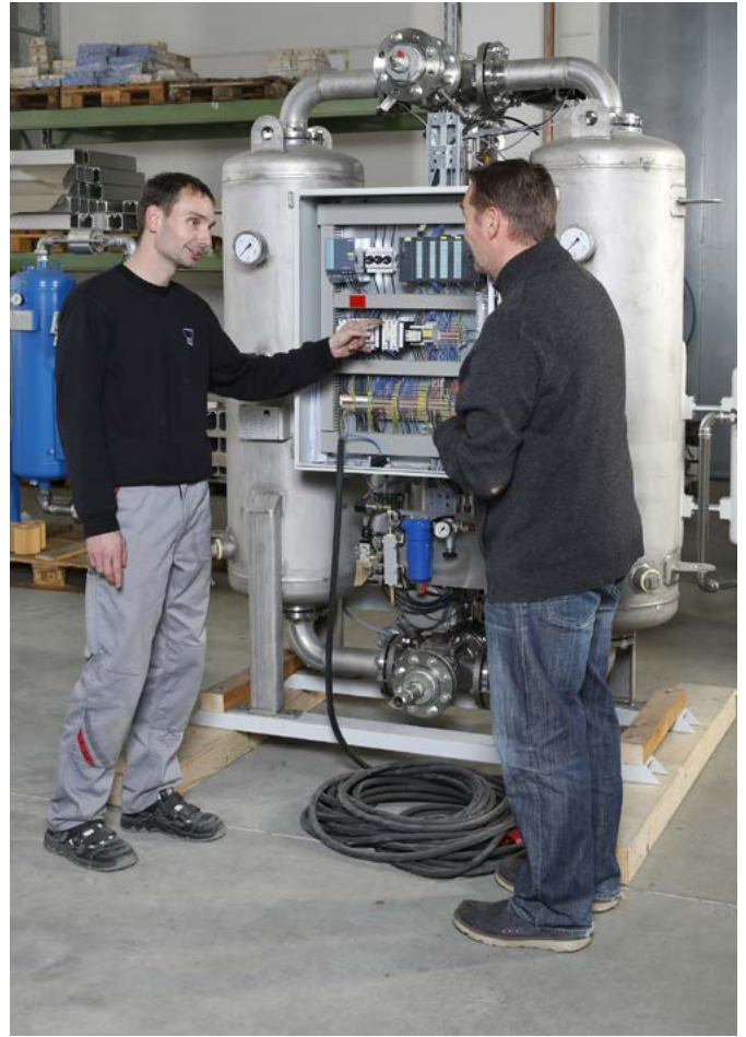
Tests finales para un secador de adsorción de regeneración en caliente de acero inoxidable
