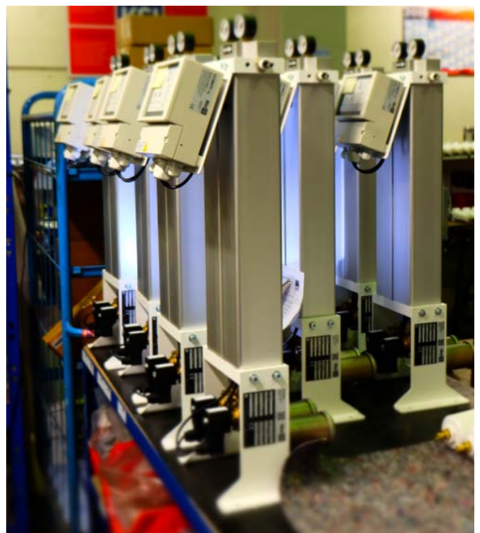
Ensamblaje final de secadores compactos
