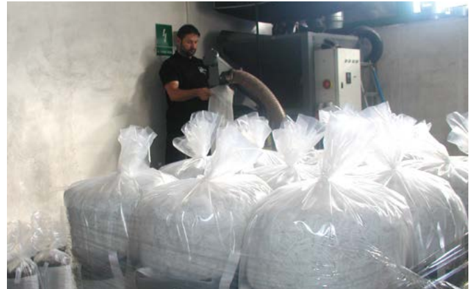
Relleno de elementos de carbón activo.
