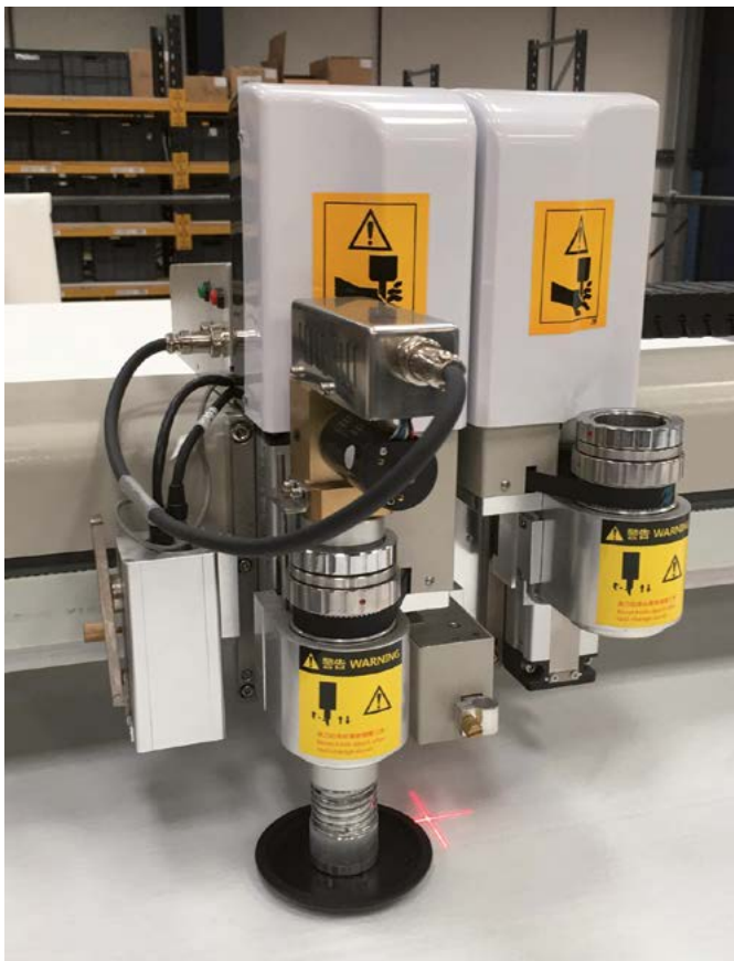
Cortadora de cuchilla para los medios de filtrado
