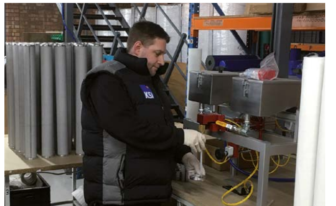
Adhesivos de dos componentes para pegar las tapas de filtro.
