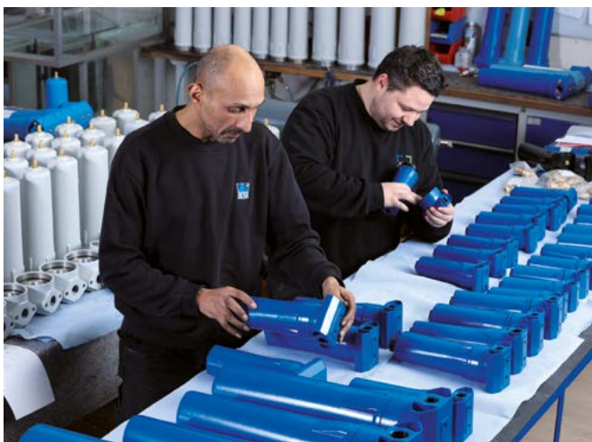
Ensamblaje de filtros de aire comprimido
